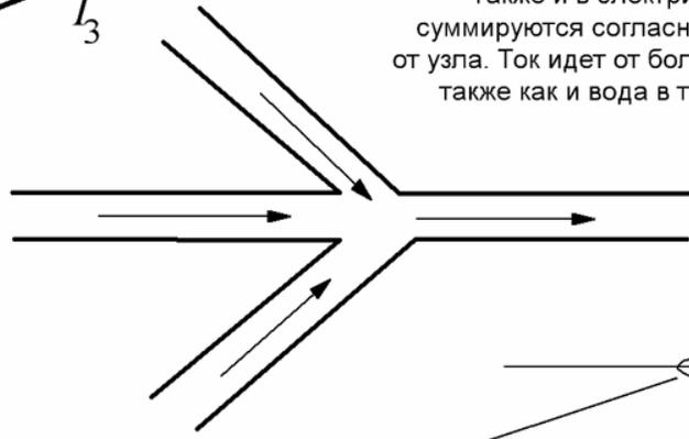
Понятие узла весьма условное. Например тут не три узла, а один так как их без проблем можно стянуть в одну точку
