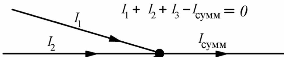
Вода в трубах не может взяться из ниоткуда, поэтому исходящий поток равен сумме входящих. Также и в электрической цепи. Токи в узле суммируются согласно их направлению: к узлу или от узла. Ток идет от большего потенциала к меньшему, также как и вода в трубе под давлением насоса.
