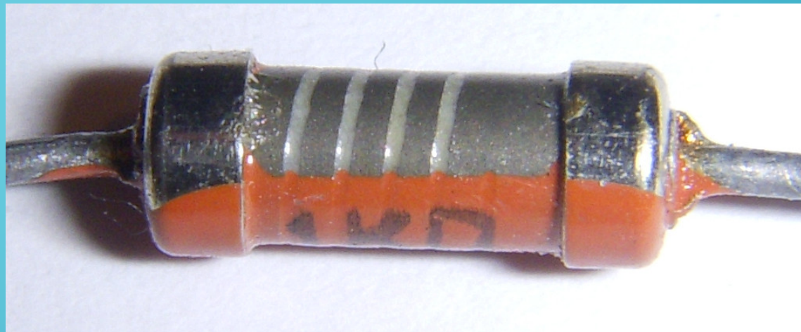
Препарированный плёночный резистор
