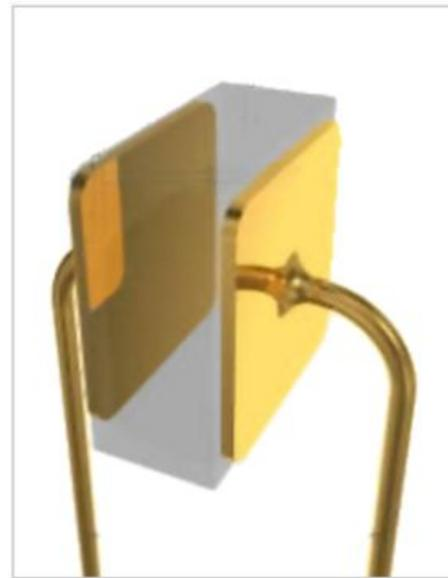
Основа конструкции конденсатора — две токопроводящие обкладки, между которыми находится диэлектрик
