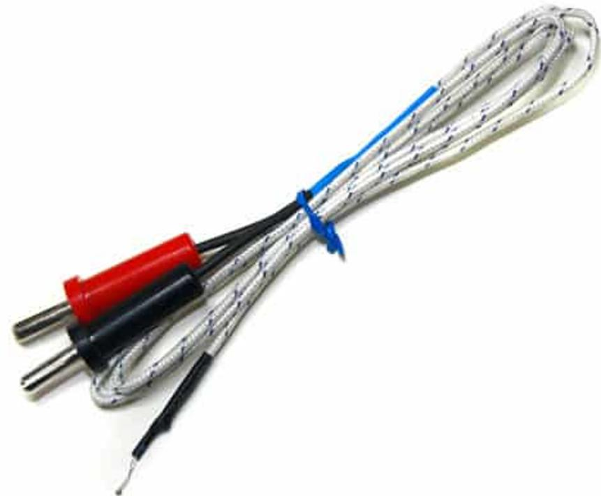
Пример - бытовая термопара типа К, средняя по чувствительности (41 мкВ/С)
